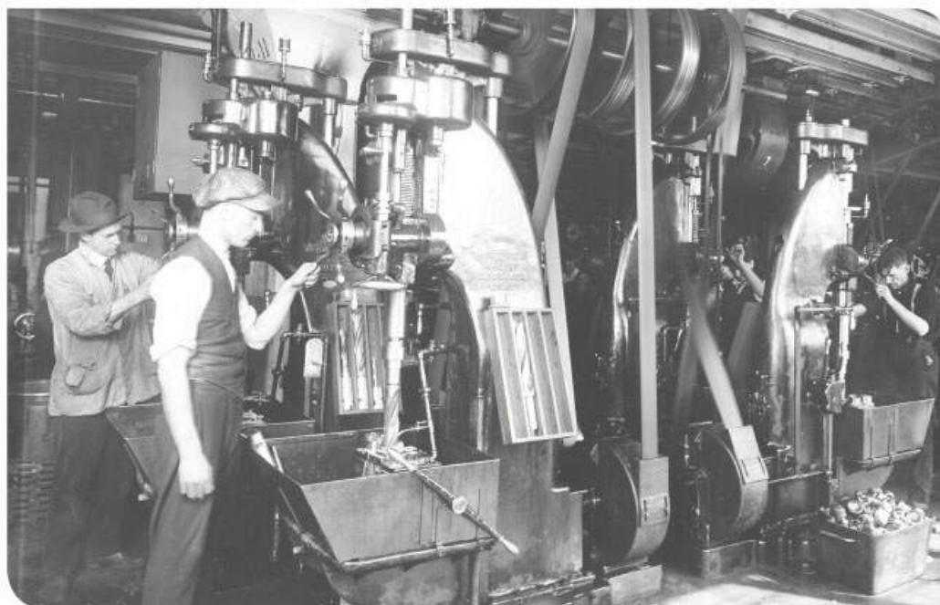
Figura 2.4 Obreros operando diversas máquinas para elaborar las piezas de un motor de automóvil.
